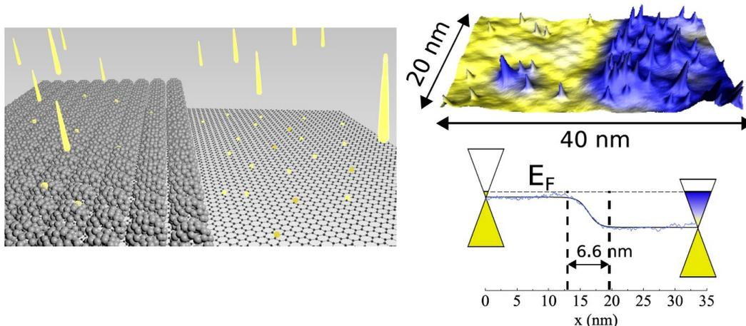
Figure : À gauche, schéma représentant un îlot de molécules de C60 utilisé comme masque pour protéger le graphène lors du dopage par exposition à de l'azote activé par une source plasma.
