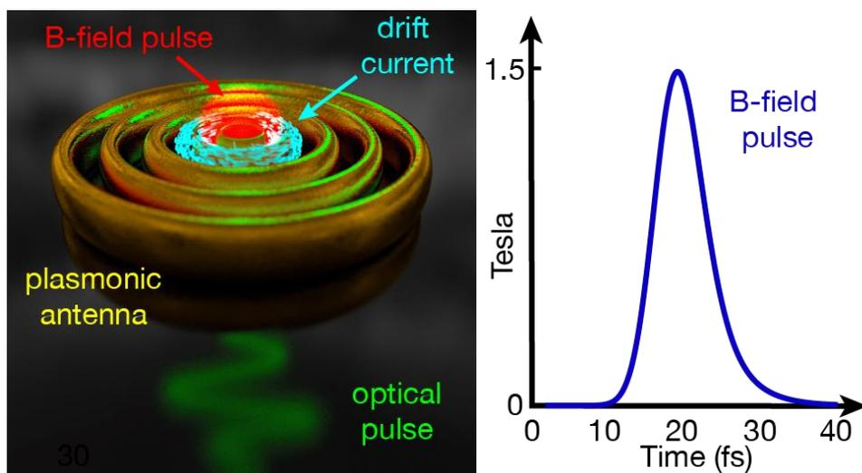
**Légende :** Une nanostructure plasmonique excitée par un éclair optique ultra rapide permet de confiner les champs optiques et de mettre en mouvement les électrons du métal. Ils génèrent à leur tour un champ magnétique stationnaire, intense, ultrabref et confiné à l'échelle nanométrique.
