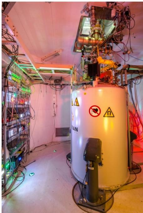
(gauche) Le dispositif PENTATRAP se compose de cinq pièges dits de Penning disposés les uns au-dessus des autres (la "tour" jaune au milieu). Dans ces pièges de construction identique, les ions à l'état excité et à l'état fondamental peuvent être mesurés en comparaison. Pour minimiser les erreurs, les ions sont également déplacés d'un piège à l'autre pour des mesures de comparaison. Crédit : MPI pour la physique nucléaire, Heidelberg.
