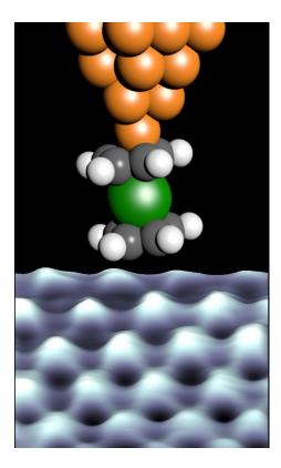
Représentation de la jonction du microscope à effet tunnel avec en gris la surface sondée et en orange la pointe en cuivre sur laquelle est greffée la molécule de nickelocène (en vert l'atome de nickel, en gris les atomes de carbone et en blanc les atomes d'hydrogène). © IPCMS (CNRS/Univ. Strasbourg)
