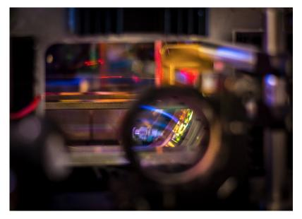
Image d'une nanofibre optique (en rouge) à l'intérieur d'une chambre à vide. Des atomes froids sont piégés autour de la fibre, à environ 200 nanomètres de la surface, et interfacés via la lumière guidée. Ces « atomes fibrés » constituent une plateforme intégrée pour les réseaux d'information quantique et un nouveau champ d'investigation pour l'électrodynamique quantique en guide d'onde. © N. V. Corzo, LKB (CNRS/Sorbonne Université/ENS Paris/Collège de France)
