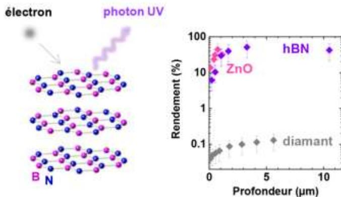
Les cristaux lamellaires de nitrure de bore hexagonal émettent dans l'ultraviolet lorsqu'ils sont excités par un faisceau d'électrons. Les mesures montrent que leur rendement quantique interne est proche de 100 %, malgré une bande interdite de type indirect. L'oxyde de zinc (direct) et le diamant (indirect) sont présentés en comparaison.
