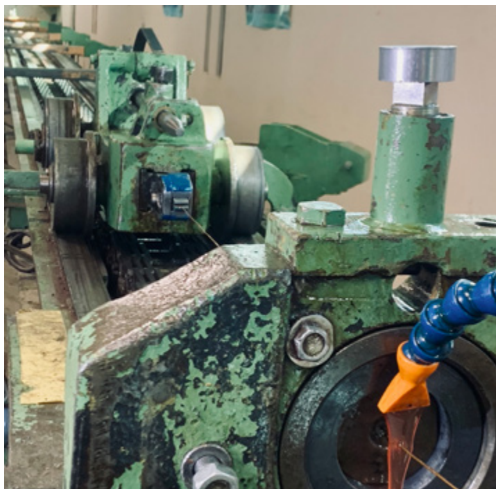
Tréfilage du cuivre au Laboratoire National des Champs Magnétiques Intenses. © Simon Tardieu
